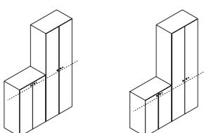
**Maniglia contenitore H 201,7.** La posizione delle maniglie è allineata con la posizione delle maniglie del contenitore alto 121,7 oppure con quelle del contenitore alto 81,7.
