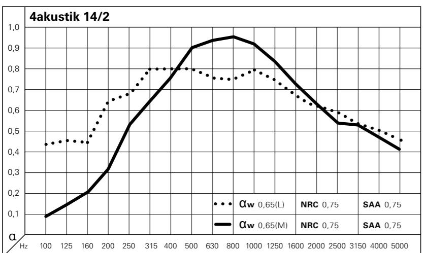
Test acustici relativi al 4akustik 14/2 per applicazioni a parete o a soffitto / Acoustic tests on 4akustik 14/2 for wall or ceiling application / Hörversuche in Bezug auf 4akustik 14/2 für Wand- und Deckenanwendung / Tests acoustiques relatifs au 4akustik 14/2 pour application au mur et au plafond / Pruebas acústicas relativas al 4akustik 14/2 para aplicación en pared y techo
